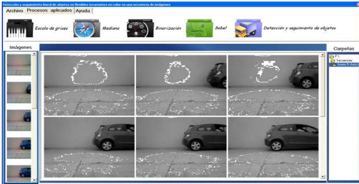
**Figura G.15.** Resultado de la aplicación del método de la mediana a la secuencia de imágenes.
