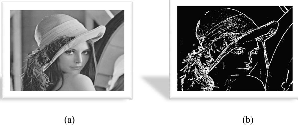
**Figura 3.7.** Aplicación de los operadores de Sobel a una imagen de entrada. (a) Imagen de entrada en escala de grises, (b) Imagen de salida bordes extraídos después de la aplicación de los operadores de Sobel.
