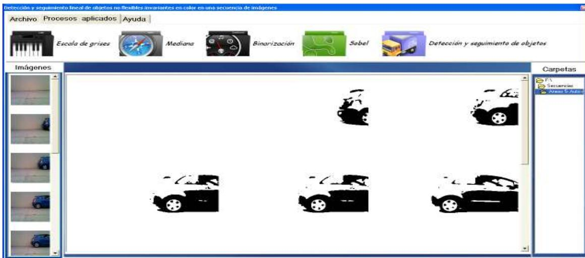
**Figura G.17.** Resultado de la aplicación del método de la binarización a la secuencia de imágenes.
